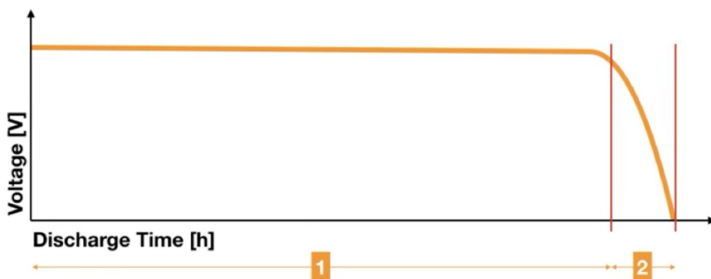
Courbe de décharge des piles au lithium
