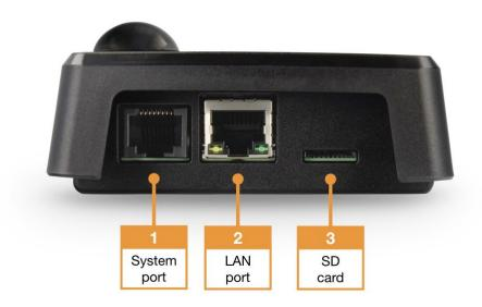
Über den Kentix Systemport (Typ A) des MultiSensors können Systemkomponenten wie z.B. Leckagesensoren, Türkontakte, Sirenen oder externe Alarme von USV oder Klimageräten angeschlossen werden. Beim MultiSensor-RF erfolgt außerdem die Spannungsversorgung über den Systemport (Typ A).
