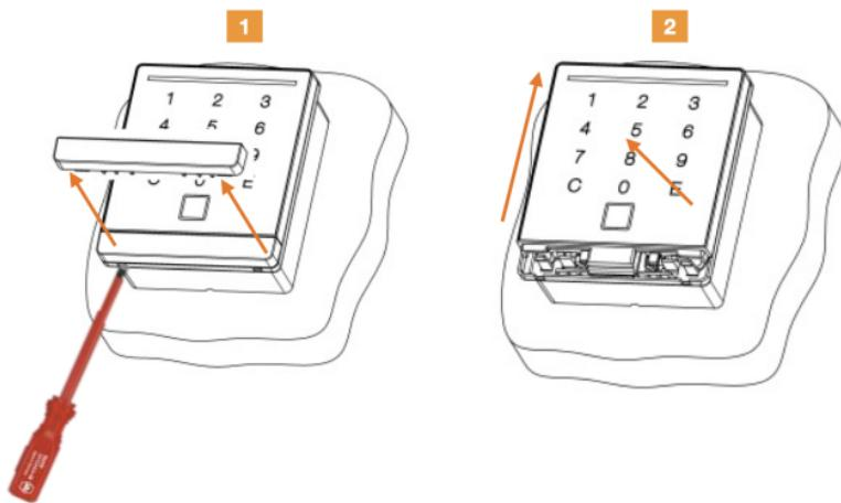
1. Schraubendreher in die Entriegelungsöffnungen einführen und Verriegelung entriegeln. Verriegelungsleiste herausziehen.
