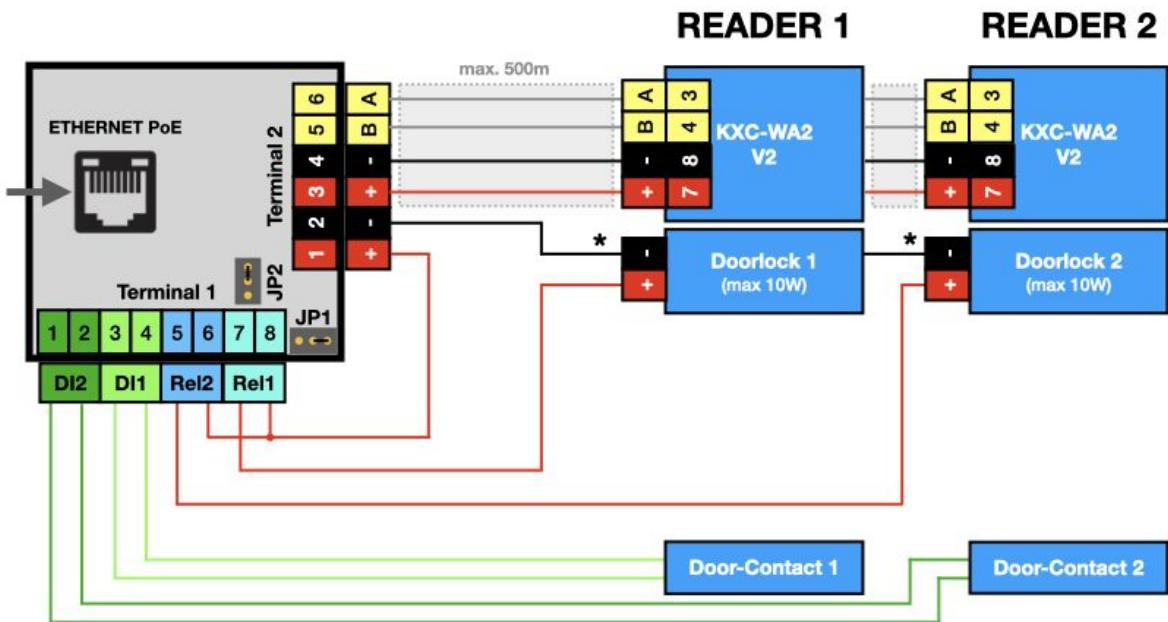
Terminal 2 am AccessManager stellt die Kommunikation über den Datenbus und die Versorgung mit Betriebsspannung für die Wandleser bereit. (Klemmen 3-6). Klemme 2 dient als gemeinsames Potential für die Stromversorgung von Türöffnern mit der PoE Versorgungsspannung des AccessManagers.
