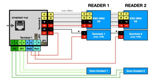
Klemmenblock 2 am AccessManager (Bus) dient zur Kommunikation (Klemmen 5 und 6) und zur Spannungsversorgung (Klemmen 3 und 4) der Wandleser.
