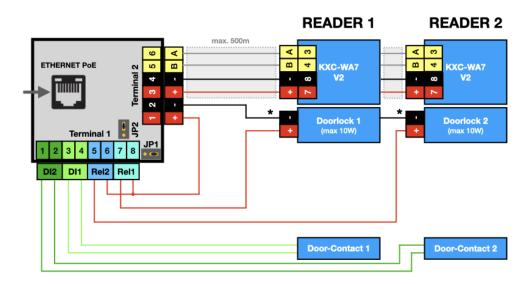
Das Anschlussbeispiel stellt schematisch die Verdrahtung von zwei DoorLock-WA7 mit Türkontakten und externen Türöffnern an einen AccessManager dar.
