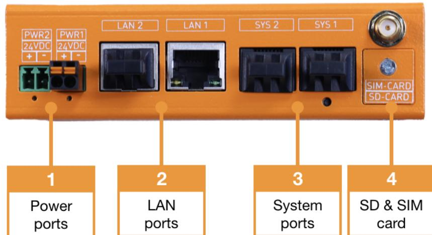
1. Anschluss 1 und Anschluss 2 zur Spannungsversorgung (24VDC) des Kentix SiteManagers
