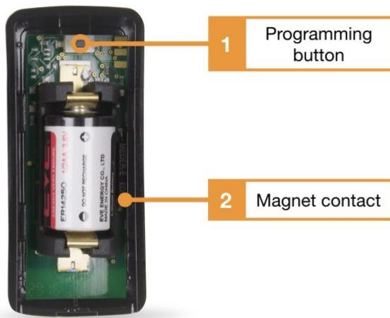
1. Einlerntaste: Diese Taste dient dem Einlernen des Geräts in das Funknetzwerk. Zum Einlernen des Sensors im Webinterface des Managers den Einlernvorgang starten und dann den Einlern-Taster 3sek. drücken bis ein Signalton zu hören ist
