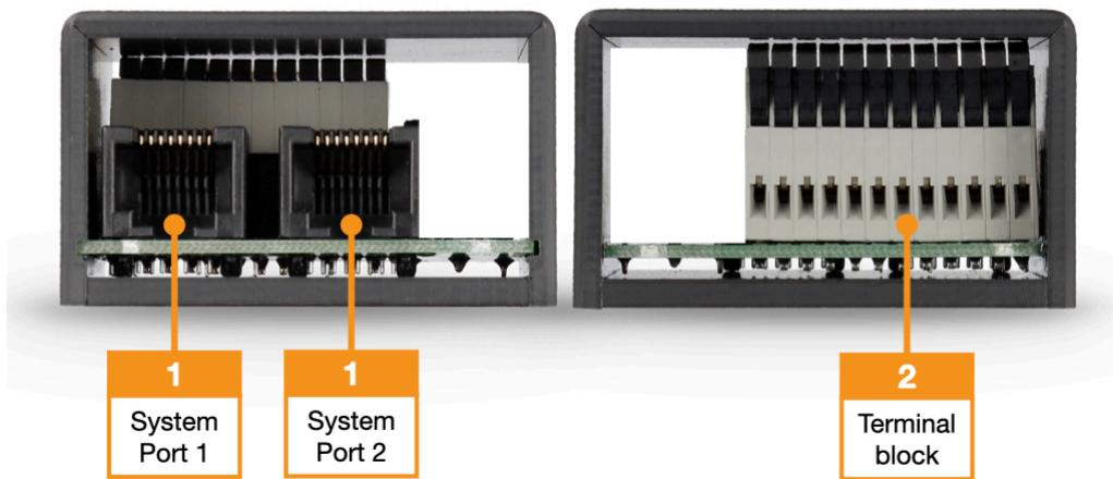
1. Kentix Systemport (Port 1, RJ45) zum Anschluss an Systemport der Gegenstelle wie z.B. AlarmManager, MultiSensor (Ethernet) oder AccessManager (Funk). Die zweite Buchse (Port 2, RJ45) dient als Ausgangsbuchse zur Weiterleitung der Signale.
