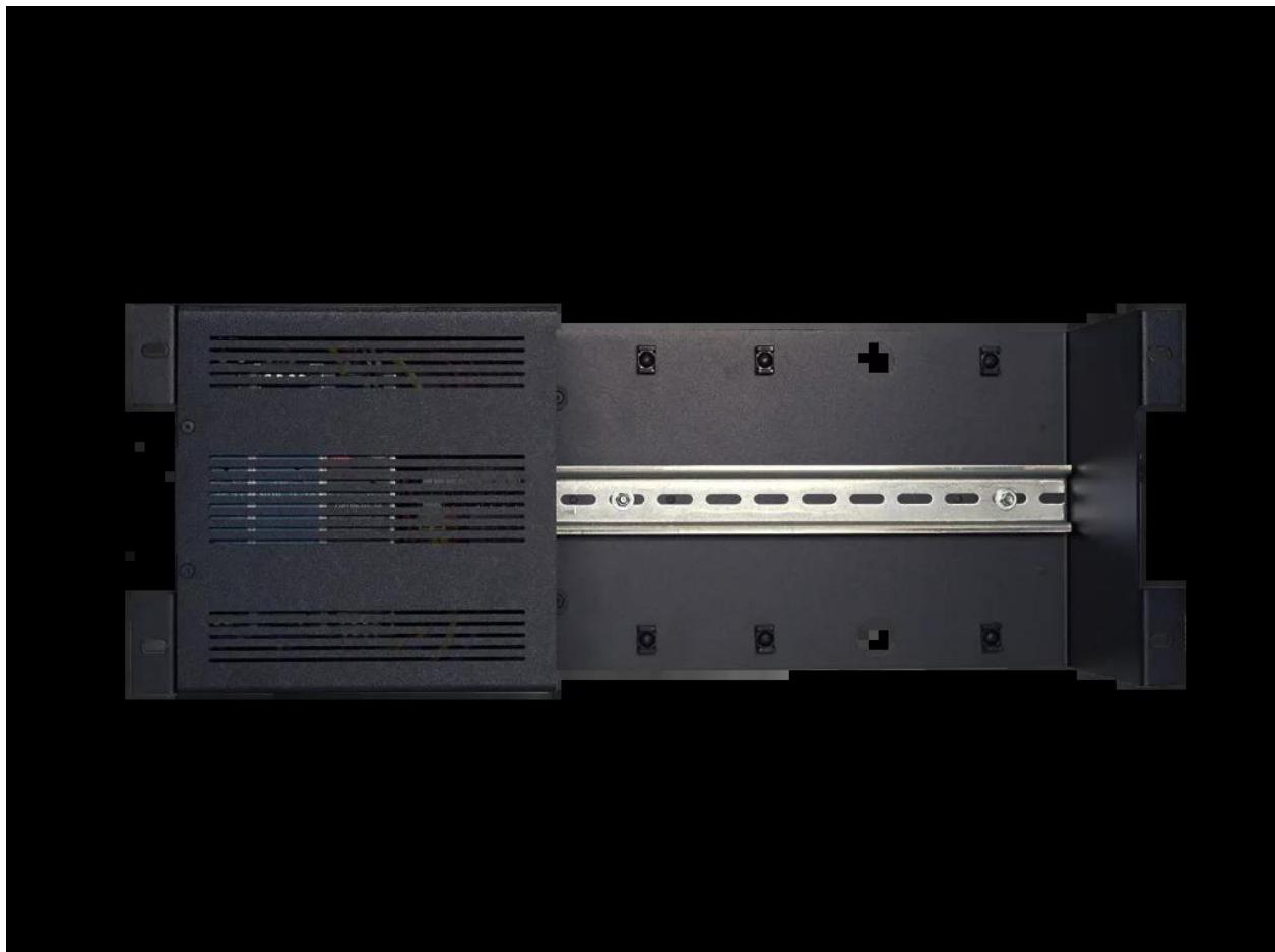
19" Montagerahmen mit 4HE zur Montage von weiteren Kentix Komponenten auf einer DIN-Schiene (35mm). Bereits vormontiert sind zwei Hutschienennetzteile mit einer Ausgangsspannung von 24VDC. Diese dienen zum Beispiel zur Spannungsversorgung des Kentix SiteManagers. Zur besseren Verdrahtung weiterer Geräte sind zusätzlich Reihenklemmen installiert.
