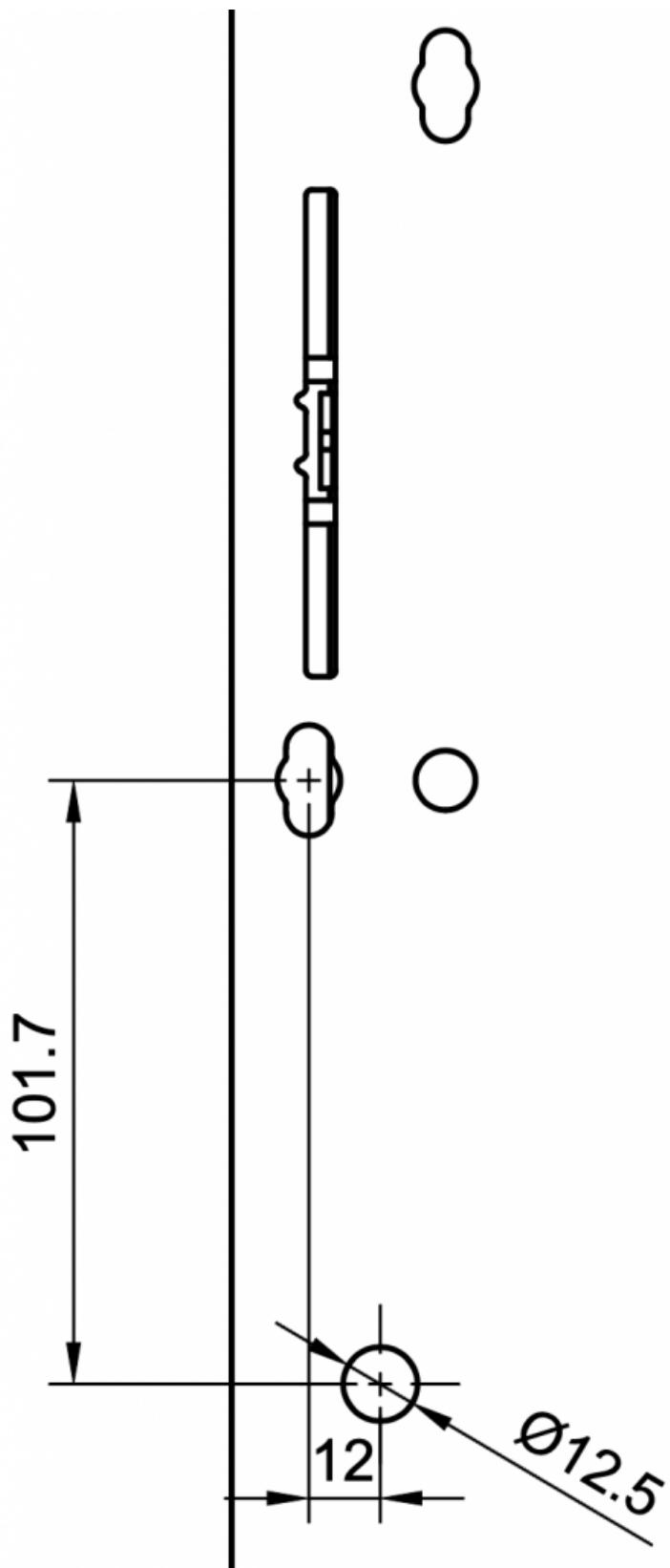
Für die Montage des DoorLock-RA4 an eine Tür wird obenstehendes Lochbild benötigt. Es muss eine Bohrung von mindestens 12.5 mm in die Tür angebracht werden, damit das Anschlusskabel durch die Tür geführt werden kann.
