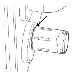
Das Batteriewechselwerkzeug auf die Markierung der Knaufhülle aufsetzen und zusammen auf den Knauf bis zum Anschlag aufschieben. Anschließend das Batteriewechselwerkzeug von der Knaufhülle entfernen und durch Ziehen an der Knaufhülle testen, ob diese fest auf dem Knauf sitzt.
