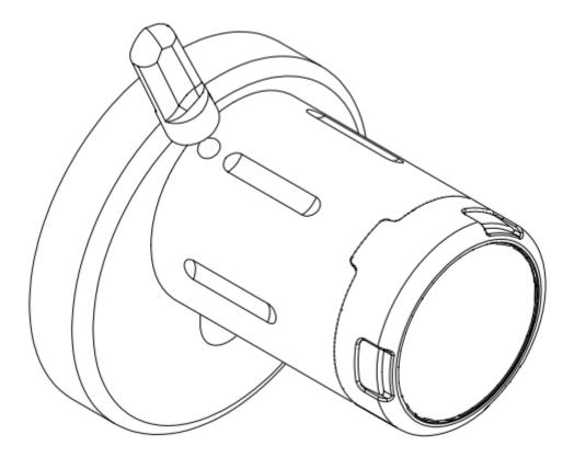
Mit aufgesetztem Batteriewechselwerkzeug die Knaufhülle abziehen.
