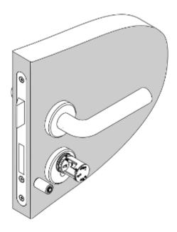
Die Knaufhülle bis zum Anschlag so auf die den Knauf aufschieben, dass die markierte Stelle auf der Knaufhülle mit dem vorstehenden Kunststoffteil auf dem Knauf fluchtet.
