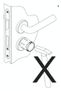
Bei der Montage dürfen keine Fremdkräfte auf den Funk-Türknauf und/oder den Zylinderkörper einwirken.
