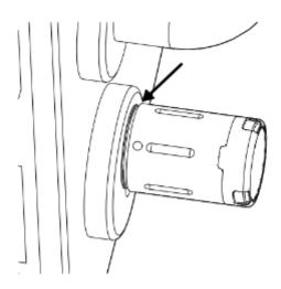
Das Batteriewechselwerkzeug auf die Markierung der Knaufhülle aufsetzen und zusammen auf den Knauf bis zum Anschlag aufschieben. Anschließend das Batteriewechselwerkzeug von der Knaufhülle entfernen und durch Ziehen an der Knaufhülle testen, ob diese fest auf dem Knauf sitzt.
