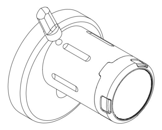
Mit aufgesetztem Batteriewechselwerkzeug die Knaufhülle abziehen.
