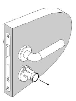
Verbrauchte Batterie entnehmen und neue Batterie einsetzen, dabei auf die Polarität achten.
