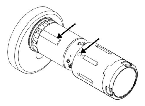
Die Knaufhülle muss soweit aufgesteckt sein, dass nur noch die Gummidichtung erkennbar ist. Wenn dies nicht der Fall ist, den Knauf festhalten und die Knaufhülle etwas auf dem Knauf hin- und herdrehen, bis die Knaufhülle sich bis zum Gummiring aufstecken lässt.
