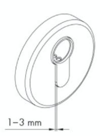
Sofern Funk-Türknauf und Zylinder nicht montiert geliefert wurden, müssen bei der Erstinstallation vor der Montage des Knaufmoduls ein oder zwei Tropfen eines harzfreien Öls (ORDER-CODE: KXC-PLS50M) in den Zylinderkörper gegeben werden. Es darf nicht direkt mit der Sprühdose in den Zylinderkörper gesprüht werden.
